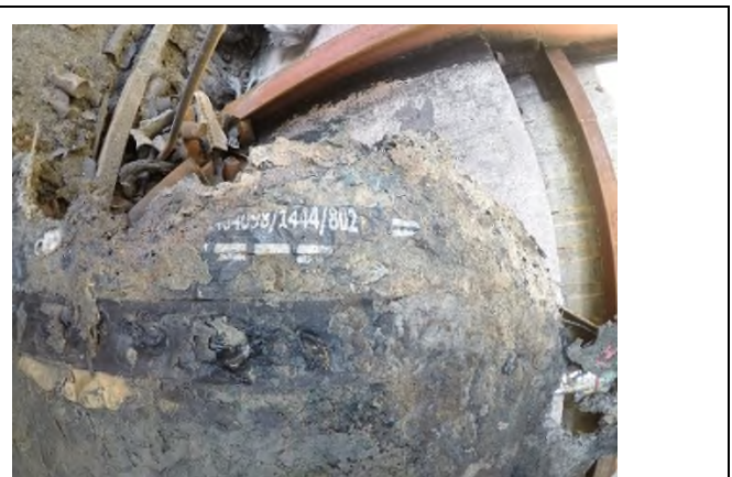
Photographie 15 : résidu du palox fondu et de sachet de protection sur les deux emplacements des caisses phyto et PNC
